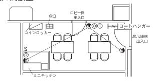
電 気 ▶ € 一壁付コンセント:3 か所(1 回路) 電 話 ▶ ① 一受発信(内線・外線) S 一臨時電話端子
